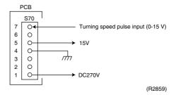
\* Propeller fan motor: S70
