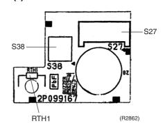
PCB(5): INTELLIGENT EYE sensor PCB
