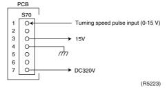
\* Propeller fan motor : S70
