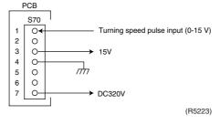
\* Propeller fan motor : S70
