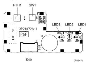
PCB(4): INTELLIGENT EYE sensor PCB
